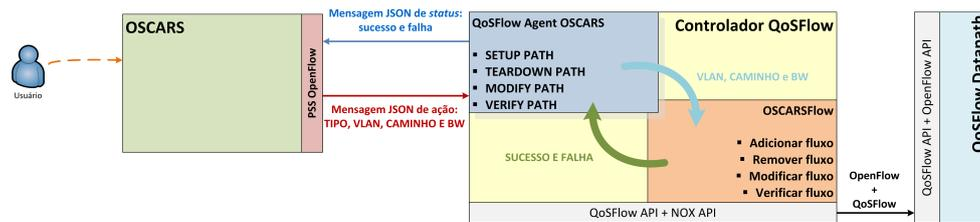
Figura 3. Integração entre as soluções OSCARS e QoSFlow.
